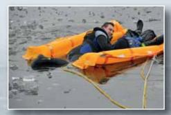
Ein im Winter durchgeführter Test bescheinigt dem Wasserrettungslift die Tauglichkeit zur Eisrettung. Eigensicherung steht hier deutlich im Vordergrund. Der Wasserrettungslift trägt den Retter sicher zur eingebrochenen Person.
