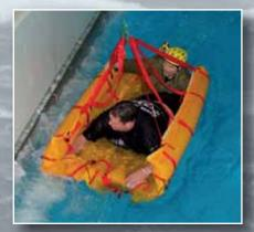
das sich bei Wasserkontakt automatisch einschaltet. Erst wenn die zu rettende Person im MOJE-M1 liegt, wird die Funktion "Liften" aktiviert (manuelles Auslösen der mittleren Kammer).
